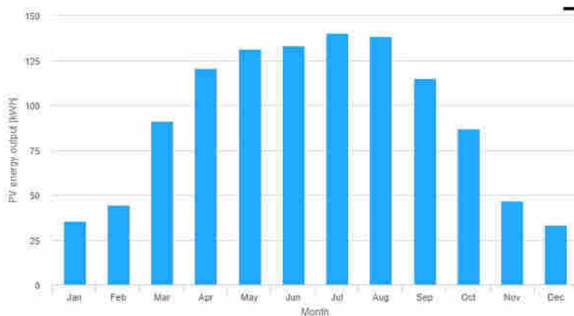
Fig. 14. Generarea lunară de energie electrică a panoului fotovoltaic monocristalin (PV) de 1kWp integrat în acoperiș
